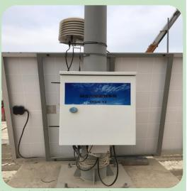
智能灑水控制系統上的塵埃感應器 **Dust sensor of Sensor-controlled Sprinkler** System
